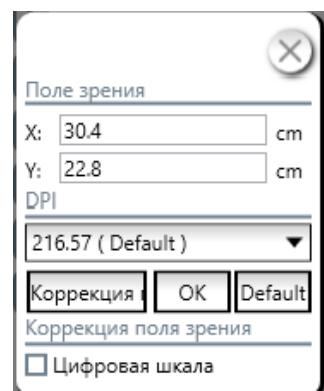
сообщении кнопку OK. Будут произведены измерение размера квадрата в пикселях и соответствующая корректировка поля зрения и DPI. Необходимо отметить, что для устойчивости выполнения данной операции рекомендуется выбирать кодировку видео YUY2. После корректировки для точного измерения расстояний в сантиметрах прямо по отображаемому
