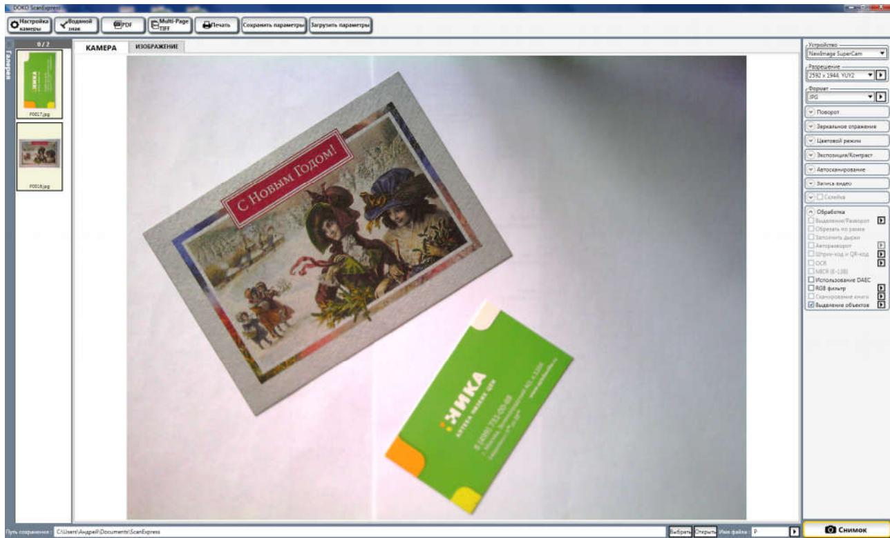
Действие функции **Обрезать по рамке** также направлено на выделение на контрастном черном фоне наблюдаемого предмета и автоматическое обрезание его снимка по прямоугольной рамке, но в отличие от команды Выделение/Разворот - уже без разворота. Поэтому целесообразно сканируемое изображение заранее выравнивать по осям, и кроме того для улучшения результата использовать предварительное ручное выделение области сканирования.
