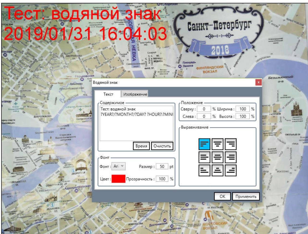
Положение текстового водяного знака на изображении задается в поле *Положение*, и здесь важно понимать общий принцип позиционирования. Водяной знак вписывается в прямоугольную область (рамку), *Ширина* и *Высота* которой задаются в процентах от соответствующих размеров формируемого камерой изображения.
