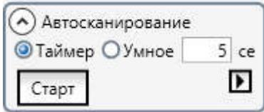
возможности: Таймер и Умное (Smart). Вариант Таймер наиболее интуитивно понятный. Выбрав его и установив желаемый интервал в секундах (в приведенном примере – 5 секунд), по нажатию кнопки Старт начнется
